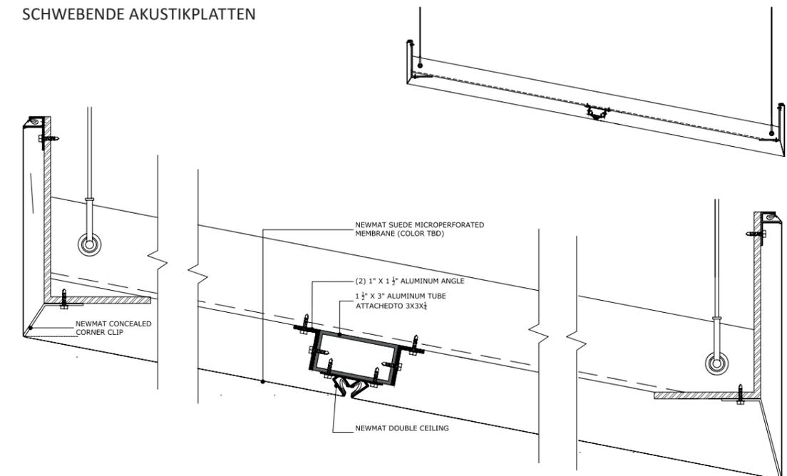
Diese Platten bestehen aus einer Stahlstruktur, die mit Glaswolle gefüllt und mit mikroperforierter Wildlederfolie überspannt ist.
