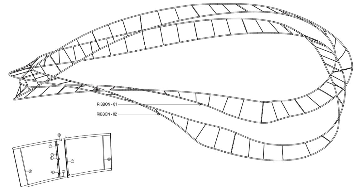
Als Reaktion auf die anspruchsvollen Montage- und Demontageanforderungen des Acura-Standes bei Automobilmessen haben wir eine Struktur entwickelt, die aus Platten mit Folienüberzug und unsichtbaren Nähten besteht und einfach und schnell zu montieren ist.
