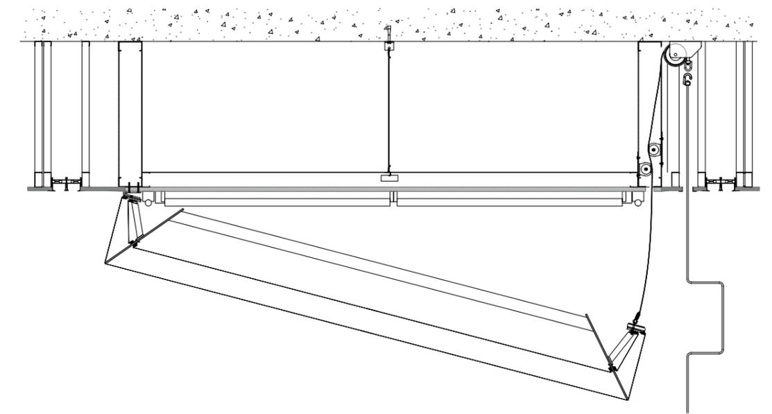
Um den Austausch der fluoreszierenden Rohre zu erleichtern, haben wir bei diesem Projekt ein manuelles Öffnungssystem entwickelt, das wir auch als elektrische Version anbieten.
