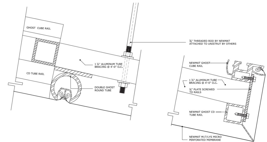
Diese Struktur wurde in unserer Werkstatt hergestellt, in 6 Segmente aufgeteilt und anschließend zur Baustelle geliefert, wo sie vor der Installation der akustischen Folien vor Ort montiert wurde.
