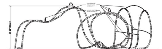
Die Herausforderung dieser Struktur bestand darin, das Randrohr so zu biegen, dass diese komplexe Form entsteht, und dabei gleichzeitig die Abstimmung der Befestigungsstellen zu erhalten, damit die Folie genau der vom Architekten definierten Form folgt.
