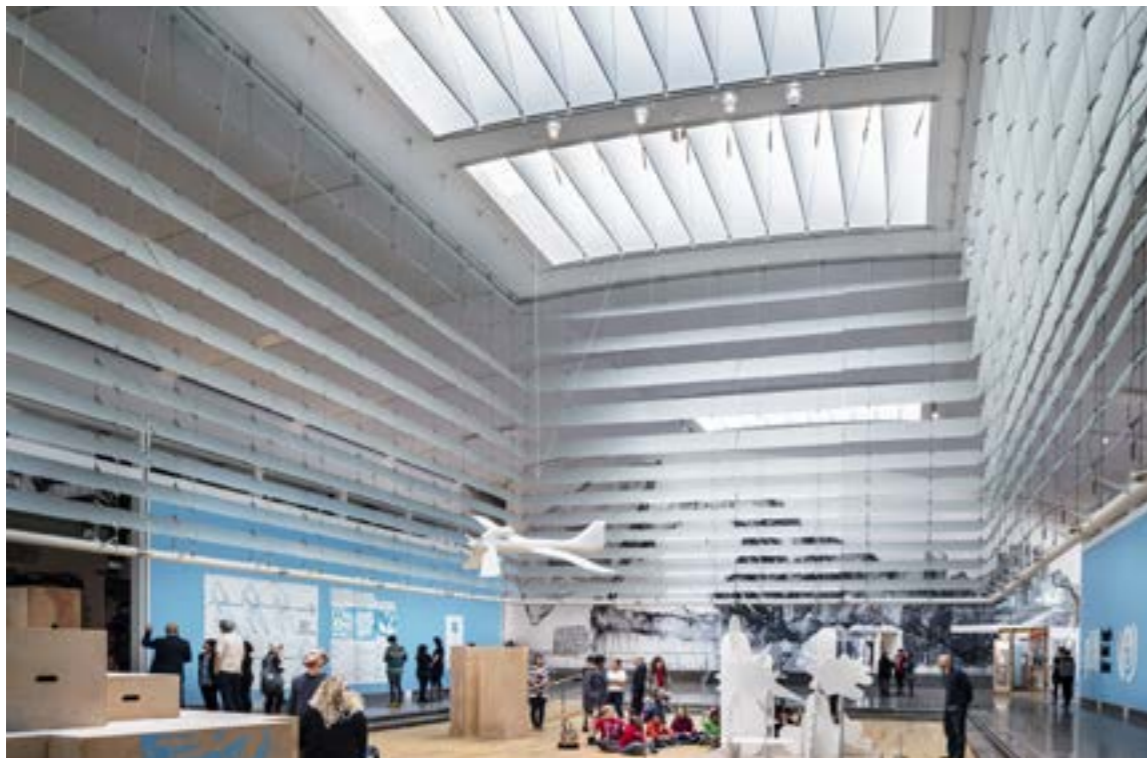
MIRODAL ACOUSTIC TOILE ACM15 / BLANC MAT MICRO-PERFORE SUR OSSATURE TUBULAIRE / SYSTEME Z-CLIP
