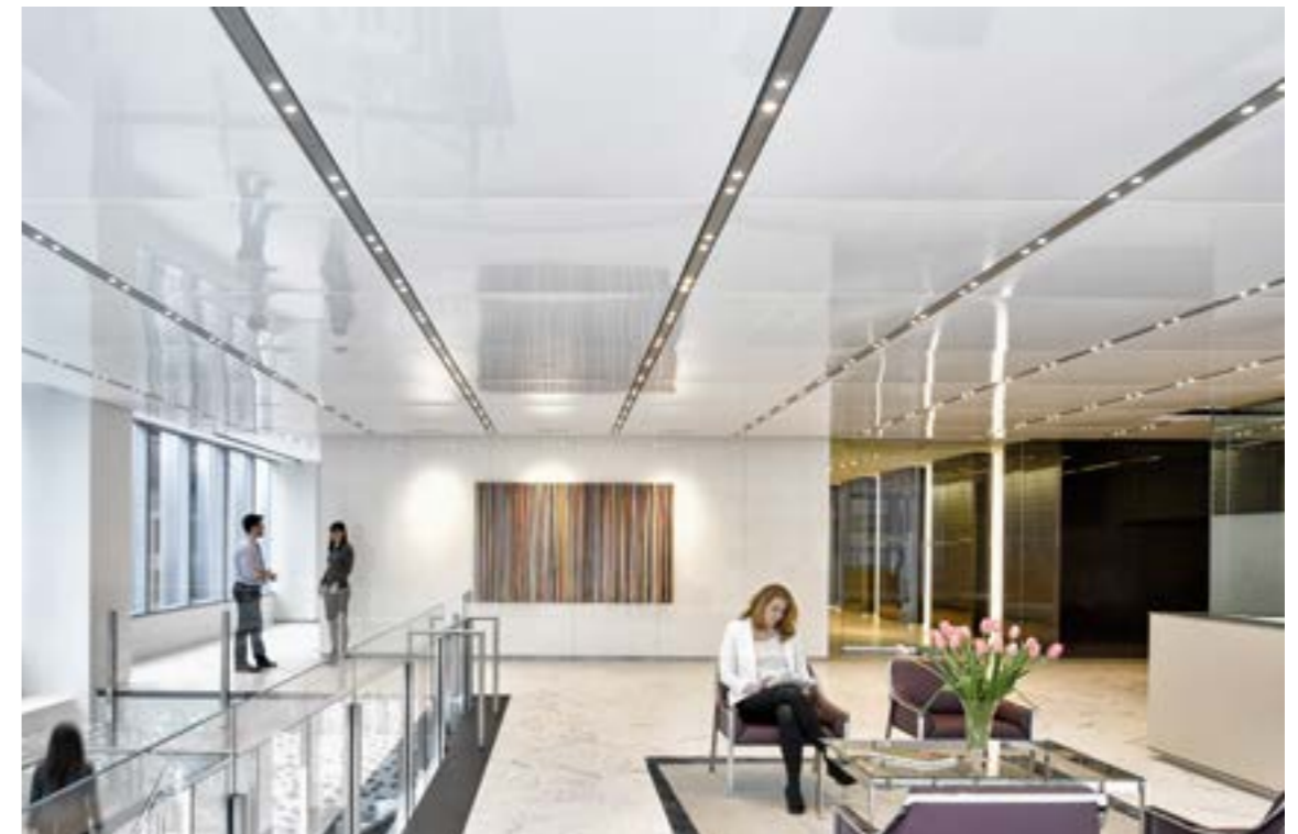
MIRODAL ACOUSTIC TOILE ACL101 / BLANC LAQUE MICRO-PERFORE / SYSTEME EZ-ACCESS ET PROFILS D'INTEGRATION DE SPRINKLERS ET DE SPOTS SUR-MESURE COMME SEPARATEURS
