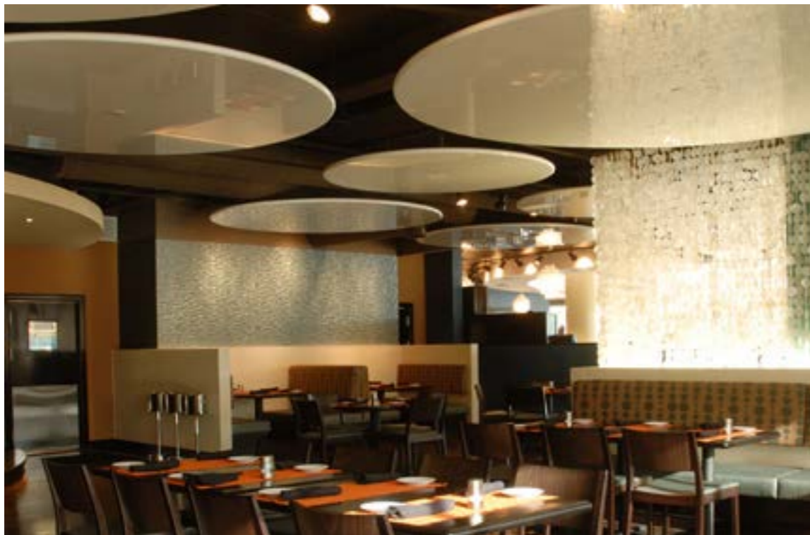
MIRODAL CIRCULAIRES DE DIAMETRES 1200, 1800, ET 2400 AVEC LISSE INVISIBLE TUBE RONDE, TOILE L1 / BLANC LAQUE / SYSTEME FLOTTANT SUT TIGES FILETEES.
