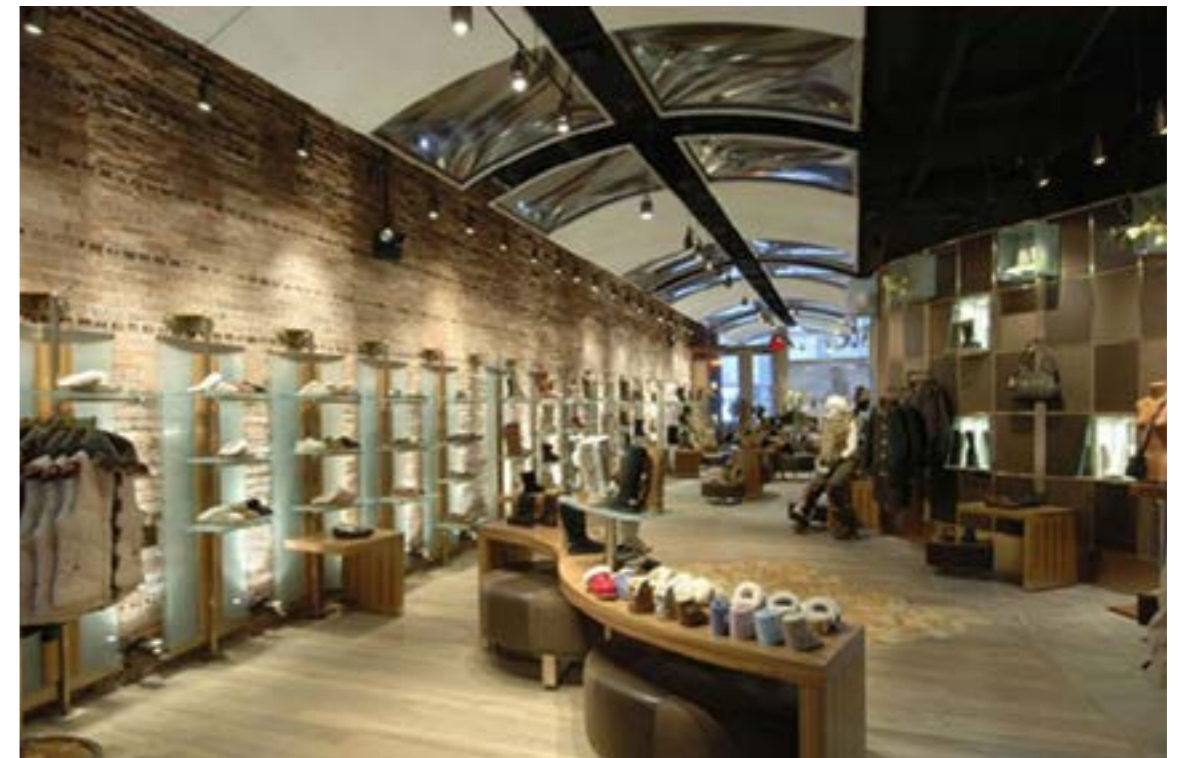
MIRODAL COURBEES AVEC LISSE INVISIBLE TUBE RONDE, DOUBLE LISSE INVISIBLE TUBE RONDE, TOILE T0B / BLANC LTRANSLUCIDE ET T10 / CRISTAL / SYSTEME FLOTTANT SUT TIGES FILETEES.
