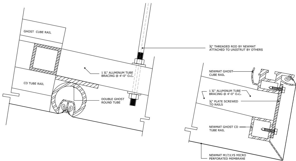
Cette structure a été fabriquée dans notre atelier, séparée en 6 segments puis livrée sur le chantier, pour y être assemblée sur place avant l'installation des toiles acoustiques.
