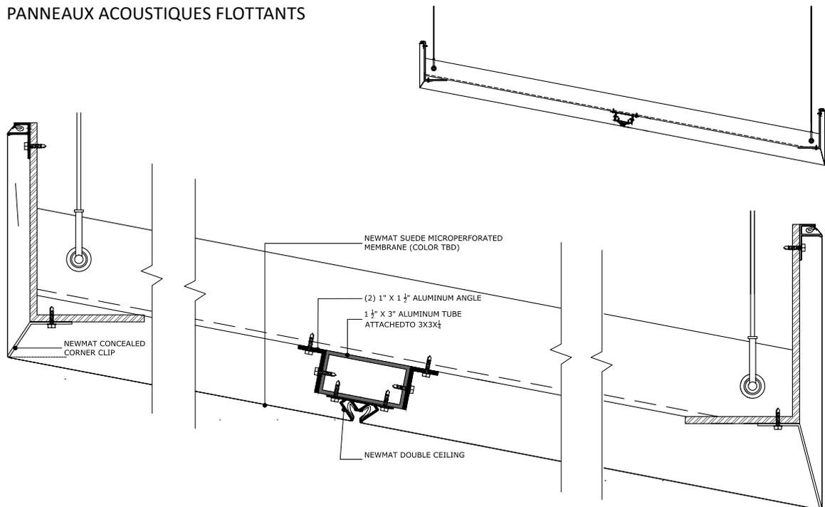
Ces panneaux sont constitués d'une structure en acier remplie de laine de verre et recouverte de 450m<sup>2</sup> de toile daim micro-perforée.
