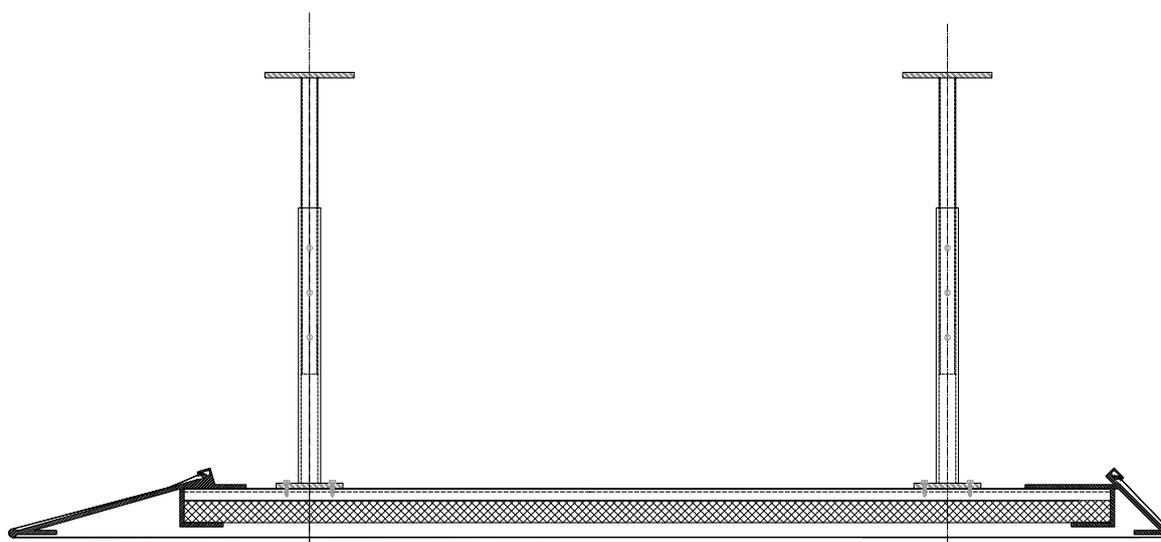
Nous offrons ces profils biseautés en 13, 30, et 45 degrés. Pour les courbes horizontales nous élaborons la forme du profil en éléments composés.
