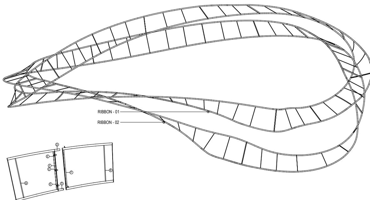
Pour répondre aux contraintes de montage et démontage du stand Acura, lors des salons automobiles, nous avons développé une structure composée de panneaux recouverts de toile avec des jonctions invisibles permettant un assemblage simple et rapide.
