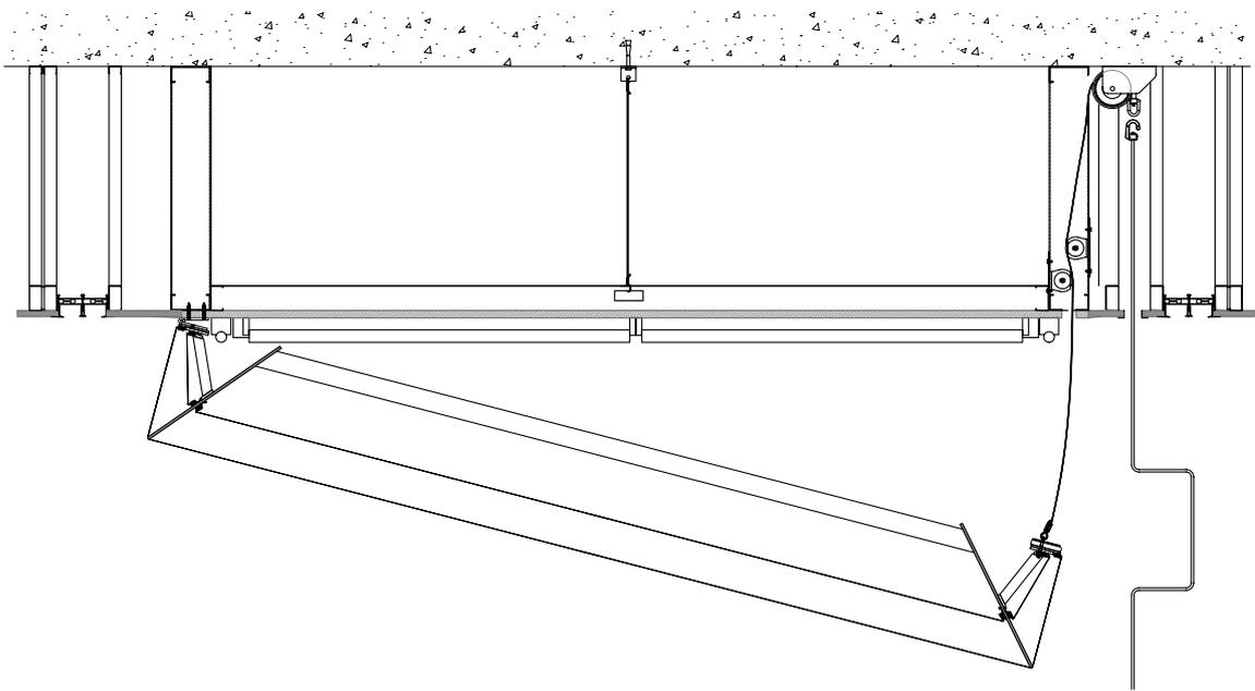
Pour faciliter le remplacement des tubes fluorescents, sur ce projet nous avons développé un système d'ouverture manuelle, disponibles aussi en version électrique.
