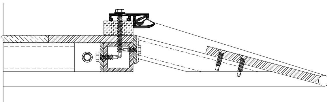
André Kikoski a imaginé cet élément de plafond en s'inspirant de l'architecture du Guggenheim. Pour réaliser ce concept, NEWMAT a construit une ossature sur mesure recouverte de toile M15 avec un système lumineux entre chaque palier.
